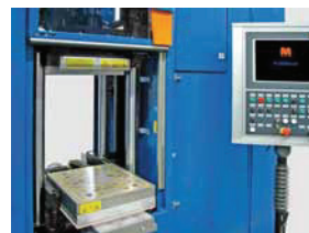
M-TECS 210 при обработке резины и реактопластов; рабочая температура – до 240°C
